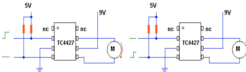
Come si nota dalle due figure alzando ora un bit ora l'altro si ottengono le rotazioni in senso orario ed antiorario.
