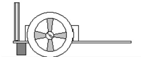
Lo scopo di questi blocchetti e' di evitare per quanto possibile che il robot *impenni* in partenza.
