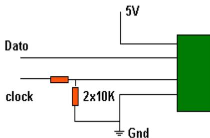
Unica accortezza il segnale del clock deve essere al massimo di 3V quindi ho adottato un partitore resistivo con due resistenze da 10K per prelevare un segnale da 2.5V adatto a pilotare il clock.
