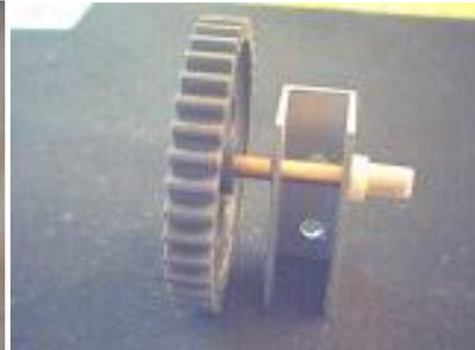
Prendete le misure sulla basetta inferiore e forate per fissare questo supporto, facendo in modo che tra ingranaggio posteriore e anteriore (misurando gli esterni) non superiate gli 8,5cm. Ripetete il tutto per l'altro ingranaggio anteriore.
